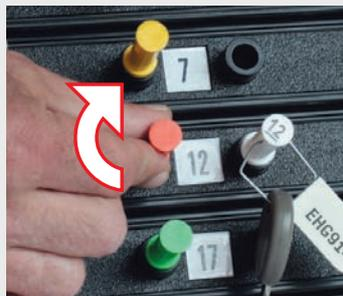
Se inserta una clavija de color para retirar la llave del sistema.
